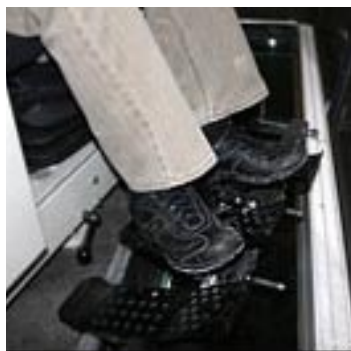
Den specialkonstruerede fodpedal bliver monteret i førerstolen hver gang Brian skal på arbejde.
